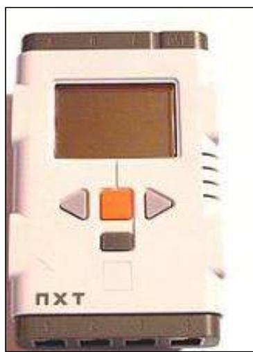
Рисунок 26 – Программируемый блок NXT
