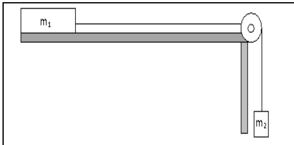
Рисунок 42 – Модель по измерению коэффициента трения скольжения
