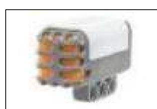
Рисунок 29 – Датчик звука
